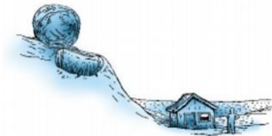
Gambar 4.2 Hilangkan ancaman dengan cara membuat lubang untuk mengubur batunya
