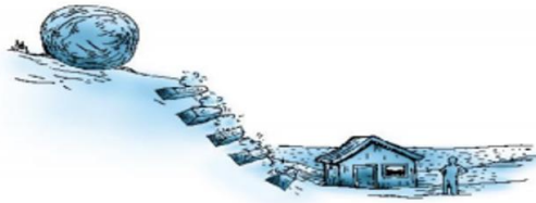
Gambar 4.8 Mitigasi ancaman dengan menanam pohon di jalur luncuran batu, bila digabungkan dengan panahan luncuran batu maka kekuatan untuk menahan luncuran batu akan menjadi semakin besar, bahkan mungkin menghentikan sama sekali luncurannya, berarti sama juga dengan menghilangkan bahayanya
