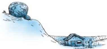
Gambar 4.6 Mitigasi ancaman dengan membangun penahan dan atau pengubah arah luncuran batu
